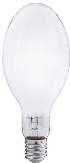
Die Thorgeon HPL 400W Quecksilberlampe ist eine zuverlässige Lichtquelle für industrielle und öffentliche Bereiche. Mit E40-Sockel, 4000K kaltweißem Licht und 22.000 Lumen sorgt sie für helle Beleuchtung. Die Lampe bietet eine Lebensdauer von 10.000 Stunden und eine Effizienz von 55 lm/W. Dank universeller Brennposition ist sie flexibel einsetzbar.
